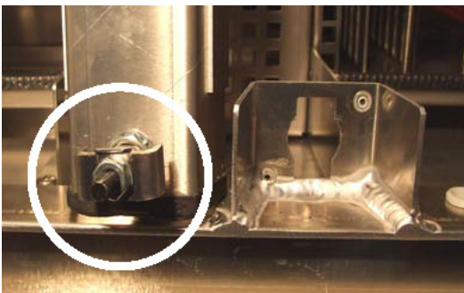
Bild Mittelsteg: Rückseite der Verriegelung und Aufnahmeplatte im Gehäuse.
